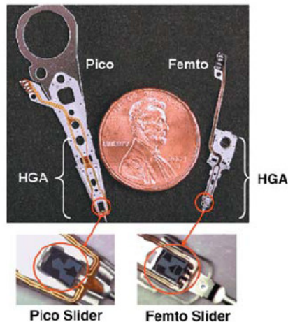
Figura 1.3 - Comparação entre um pico slider e um femto slider, e suas respectivas suspensões.
