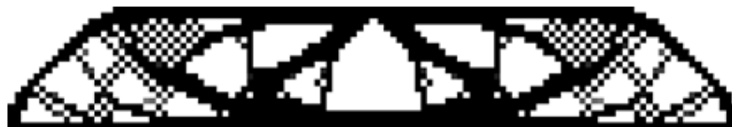
Figura 3.10 - Topologia apresentando instabilidade tabuleiro.
